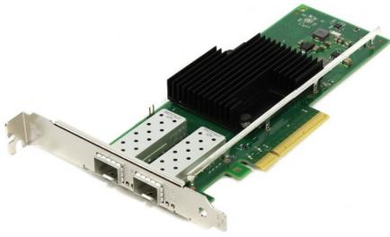
Intel X710 10-GbE-Ethernet-Converged-Netzwerkadapter mit zwei SFP+-Ports
