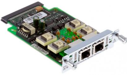
Cisco VIC3-2E/M Sprachschnittstellenkarte mit zwei Anschlüssen – E und M
