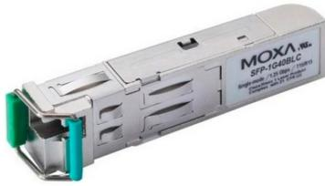
Moxa SFP-1G40BLC WDM-Typ (BiDi) SFP-Modul mit 1 1000BaseSFP-Port mit LC-Anschluss für 40 km Übertragung; TX 1550 nm, RX 1310 nm, 0 bis 60 °C Betriebstemperatur
