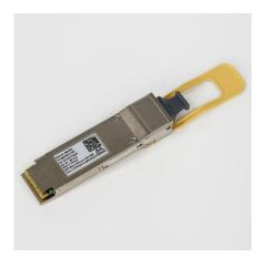
Mellanox MMA1B00-C100D-Transceiver, 100 GbE, QSFP28, MPO, 850 nm, SR4, bis zu 100 m, DDMI MMA1B00-C100D
