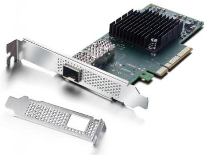
Mellanox MCX4111A-ACAT ConnectX-4 Lx EN Netzwerkschnittstellenkarte, 25 GbE Single-Port SFP28, PCIe3.0 x8, hohe Halterung
