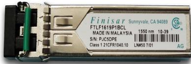
Finisar FTLF1619P1BCL 1000BASE-EZX und 2G Fibre Channel (2GFC) 110 km optischer SFP-Transceiver
