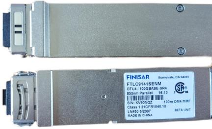
Finisar FTLC9141SENM 100GBASE-SR4 und OTN Multirate 100m CFP4 Optischer Transceiver
