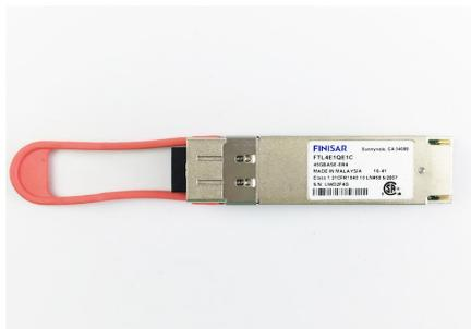
Finisar FTL4E1QE1C 40GBASE-ER4 40 km QSFP+ optischer Transceiver
