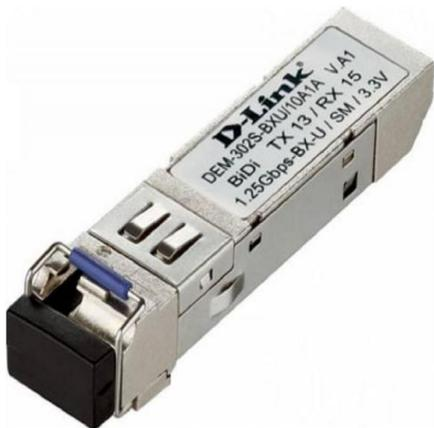
D-Link DEM-302S-BXU SFP-Transceiver 1 Port 1000Base-BX für SMF, Stromversorgung 3,3 V (bis zu 2 km), WDM (TX: 1310 nm, RX: 1550 nm)
