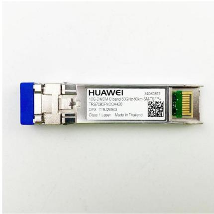
Optischer Huawei-Transceiver, TSFP+, erweitertes C-Band, 9,95 bis 11,3 Gbit/s mit CDR, -1 dBm bis 3 dBm, -16 dBm, LC, SMF, 80 km
