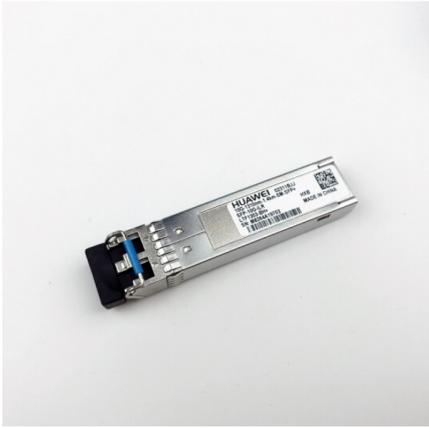
Huawei SFP-10G-iLR Optischer Transceiver, SFP+, 9,8 G, Single-Mode-Modul (1310 nm, 1,4 km, LC)
